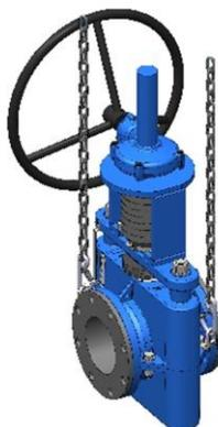
Fig.1 Manejo con cáncamos
